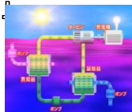
佐賀大学にて 海洋温度差 発電の原理実証 (温度差20℃で発電)
