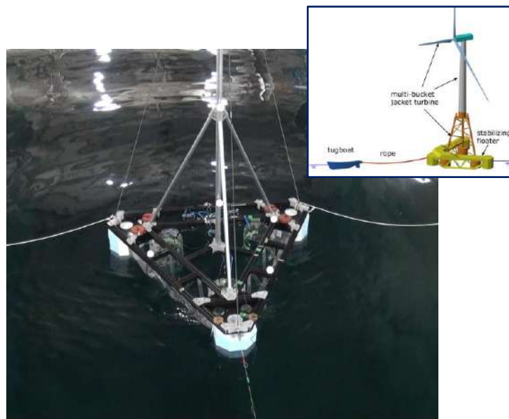
着床式風車の新しい施工工法の検証
