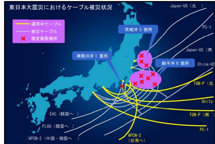
図 5. 東日本大震災におけるケーブル被災状況
