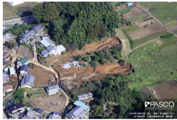
緩斜面崩壊の例
