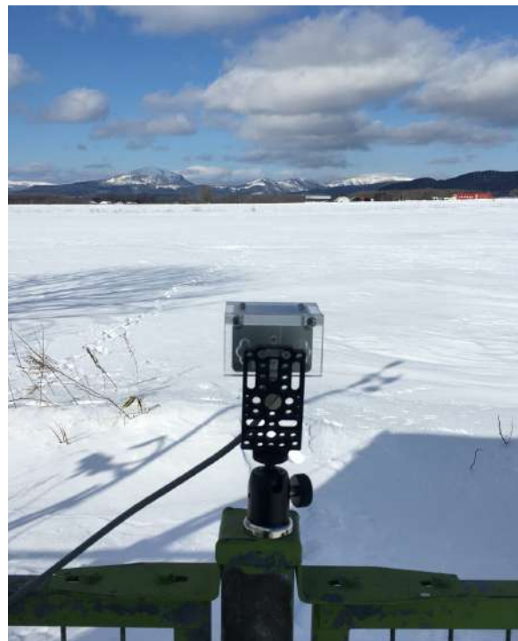
視程計やレーザー距離計など 最新の計測技術を駆使
